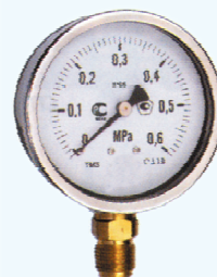
корпус - нерж. сталь, измерительный элемент и штукер - медный сплав глицеринонаполненные
