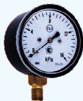
чувствительный элемент - металлическая мембранная коробка
